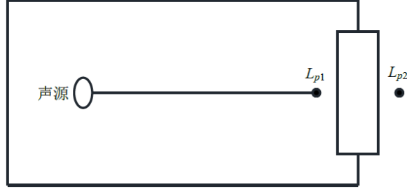
图 6.2-4 室内声源等效为室外声源图例
